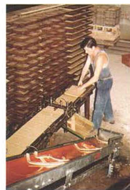
Pose de carreaux sur claies de séchage Укладывание плитки для просушки
